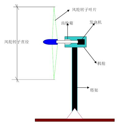
图 1.2-1 风力发电机组结构
