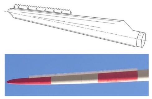
图 5.2-1 锯齿降噪结构在叶片上的整体安装效果图
