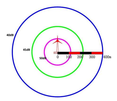
图4.1-1 单台风机噪声等声级线图
