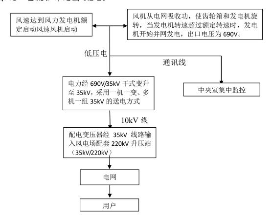
图 1.2-2 风电系统工艺流程图
