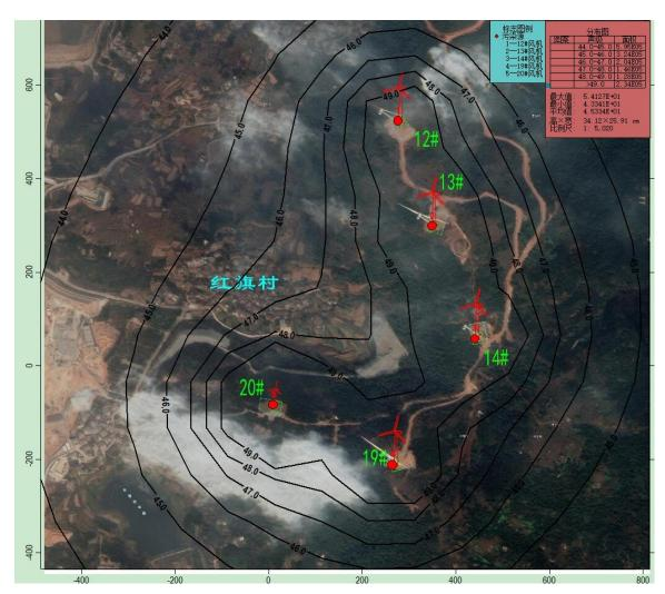
图4.2-3 正常工况下预测结果(风速8m/s及以下时)
